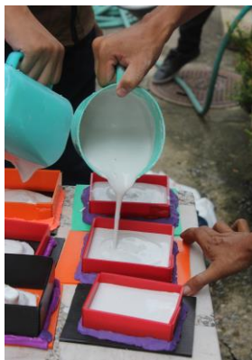
ภาพที่ 5 การเทปูนพลาสติกอร์ใส่ในแม่พิมพ์ยางซิลิโคนเพื่อใช้ทำเป็นพิมพ์ครอบ
