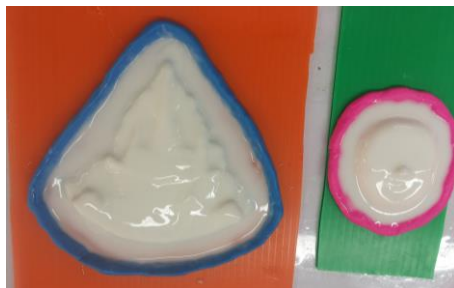
ภาพที่ 4 การทำแม่พิมพ์จากยางซิลิโคนที่ทาลงบนดินน้ำมันต้นแบบจนหนาพอสมควร
