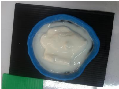
ภาพที่ 4 การทำแม่พิมพ์จากยางซิลิโคนที่ทาลงบนดินน้ำมันต้นแบบจนหนาพอสมควร
