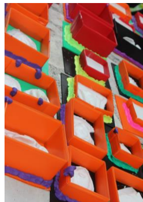
ภาพที่ 4 การทำแม่พิมพ์จากยางซิลิโคนที่ทาลงบนดินน้ำมันต้นแบบจนหนาพอสมควร
