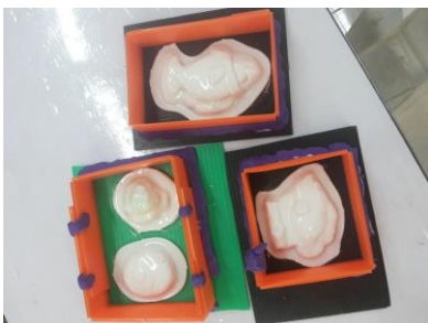
ภาพที่ 5 การเทปูนพลาสติกอร์ใส่ในแม่พิมพ์ยางซิลิโคนเพื่อใช้ทำเป็นพิมพ์ครอบ
